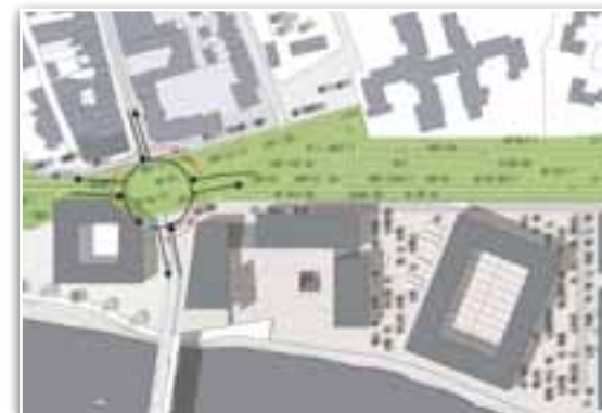
In Maaseik werd het ontwerp voor de aanleg van een klassieke rotonde op de N78 stilgelegd. Ontwerpers gingen opnieuw aan de slag en kwamen uit bij een ovonde – een ovale rotonde.
