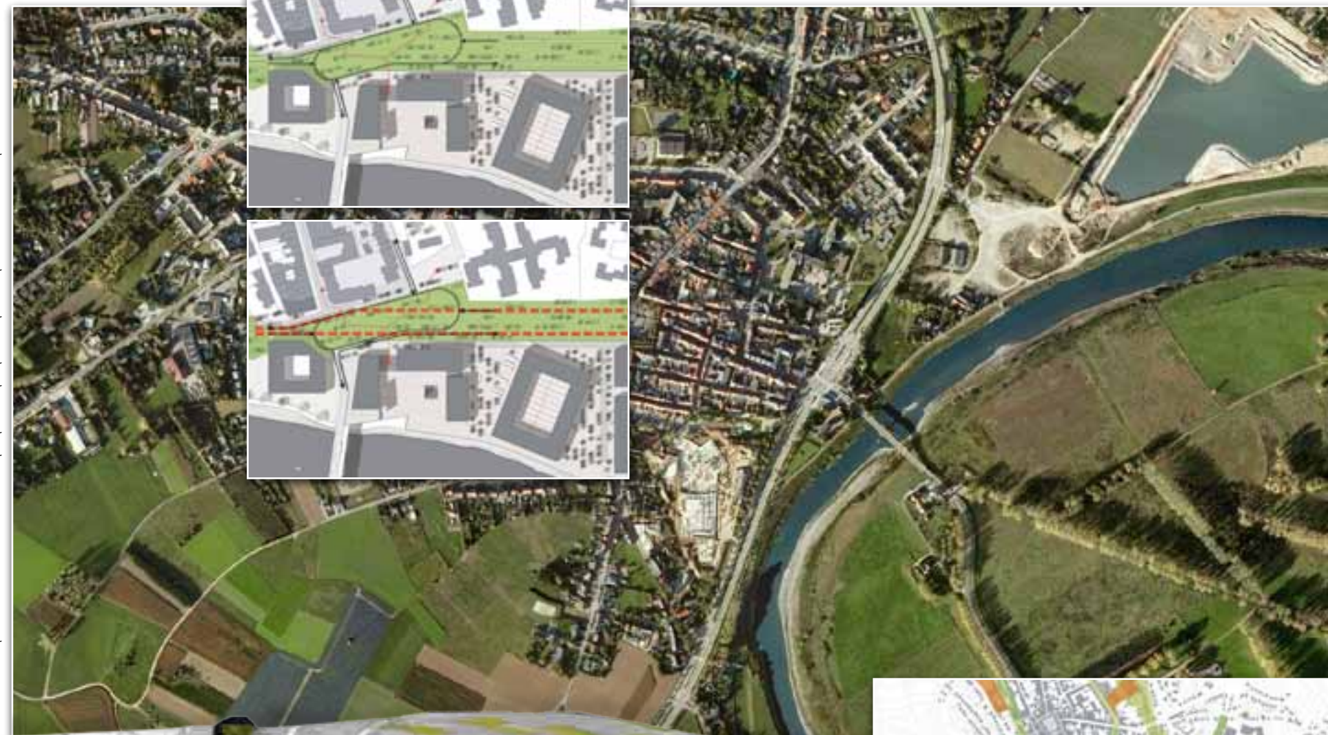
In Maaseik werd het ontwerp voor de aanleg van een klassieke rotonde op de N78 stilgelegd. Ontwerpers gingen opnieuw aan de slag en kwamen uit bij een ovonde – een ovale rotonde.
