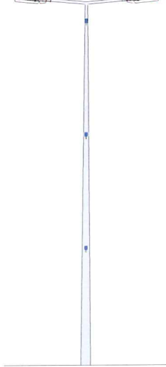
mast met signaal verlichting + twee armaturen voor straatverlichting
