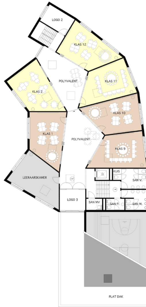
EERSTE VERDIEPING - bruto oppervlakte 467 m 2 -
