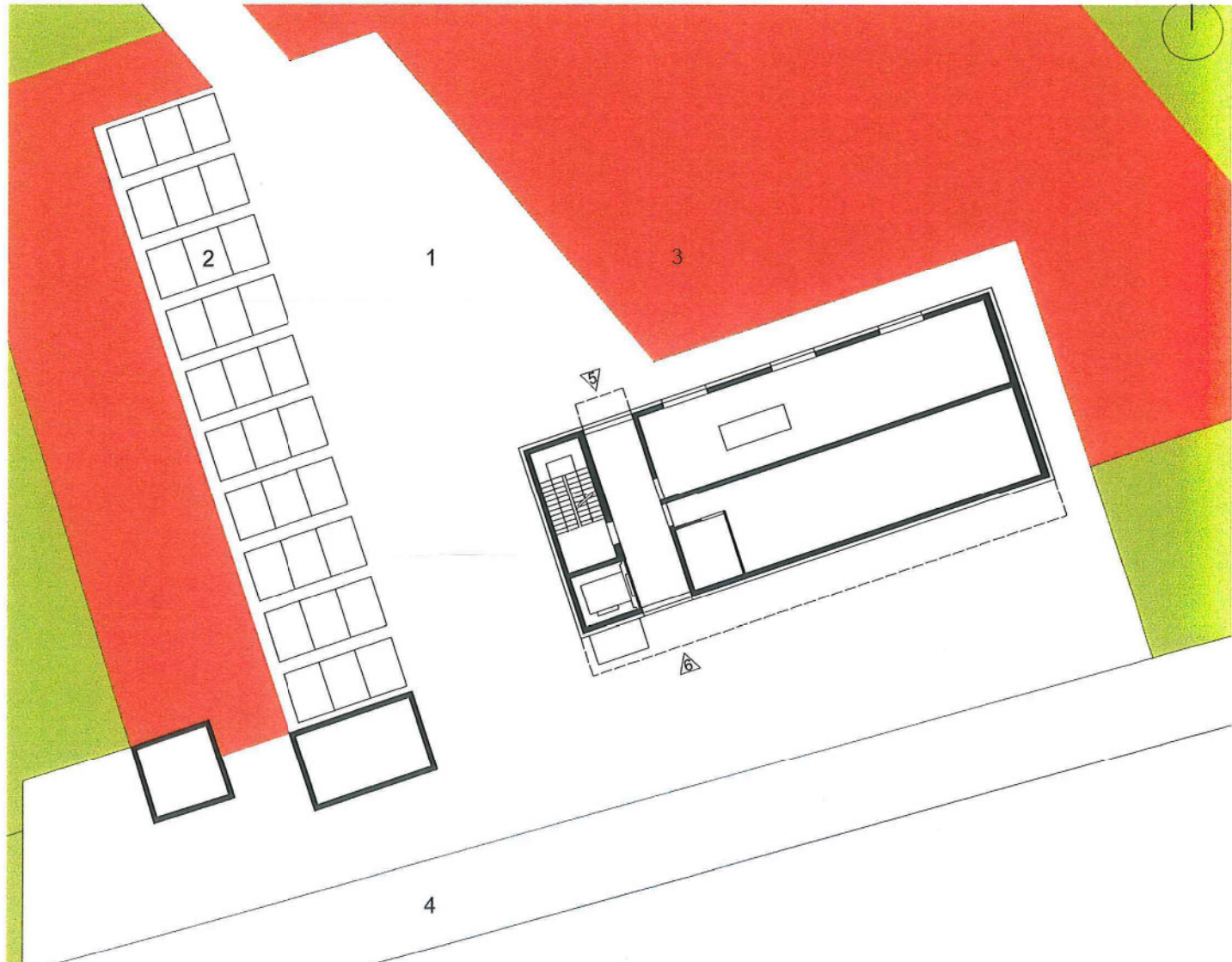
1. verharding in kasseien 2. 10 parkeerplaatsen, stelconplaten 3. nieuwe aanplanting 4. trekweg 5. toegang personeel 6. toegang bezoeker
