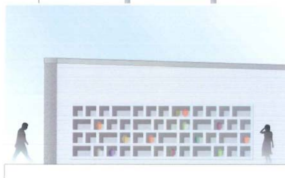
Boven: Zijaanzicht nissen in urnenmuur; maximaal 4 lagen, minimaal 1 laag hoog.
