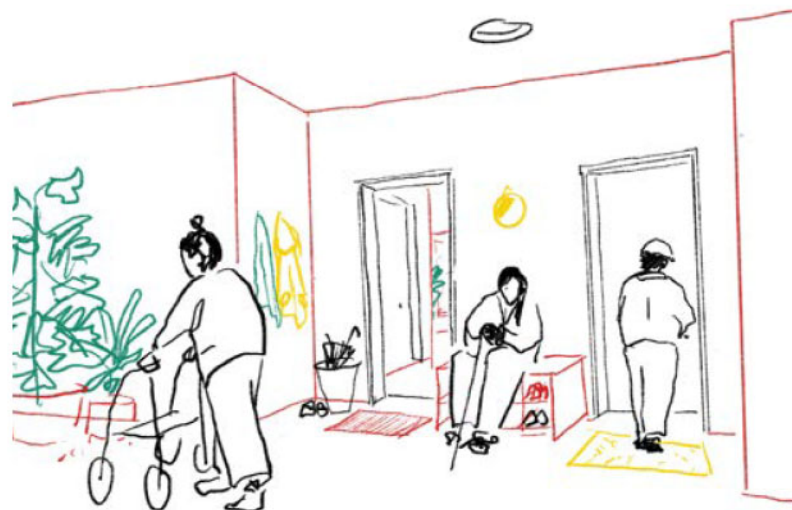
- De gang krijgt een plaatselijke verbreding door de nissen met de kamerdeuren als herkenningspunt -
