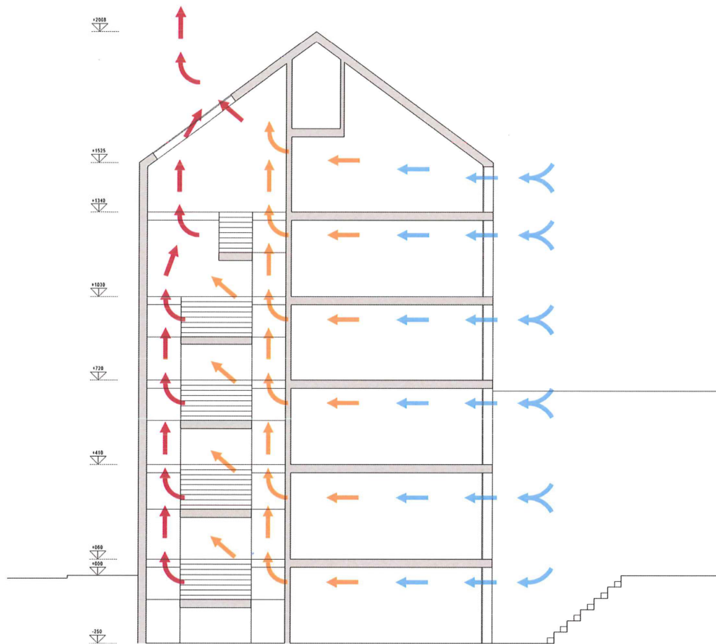
PRINCIPE : VERLUCHTING EN KOELING GEBOUW
