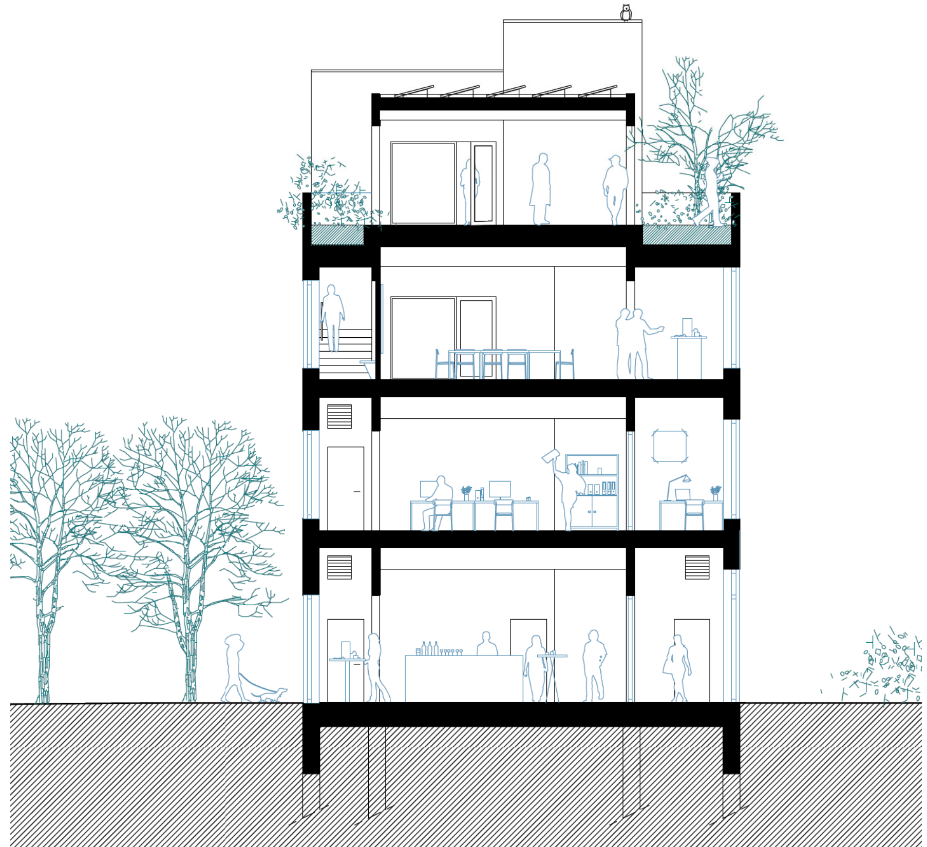
Dwarsdoorsnede met de stapeling van forum, werk- en vergaderplekken en belvédère met trap- en dienende zone als schil rond de kern gewikkeld.
