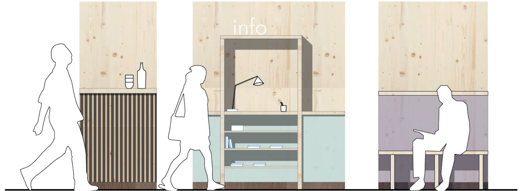
De lambrisering kan dienst doen als akoestische bekleding, als drager voor info of andere schermen, of als bank voor het tussentijds wachten.
