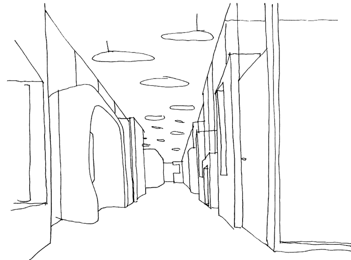
De gangzone kent een afwisseling van gesloten kasten of banken en glas, waardoor de gang schaal en geborgenheid krijgt
