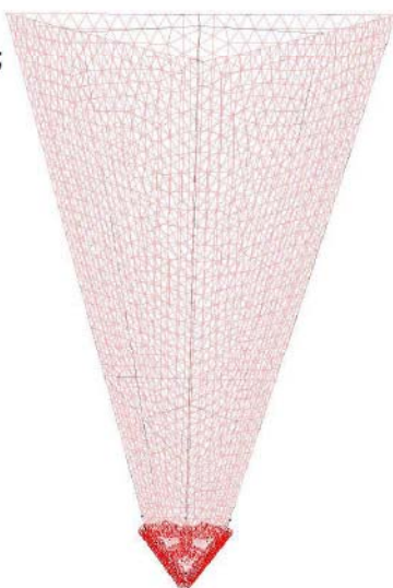
fig.2 3D-buigmomenten- en doorbuigingenmodel van de silowand;
