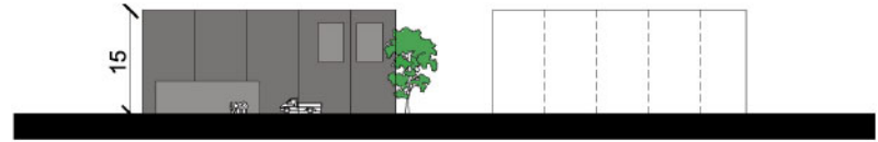
Gevelopeningen: geopende 'blinde' gevel
