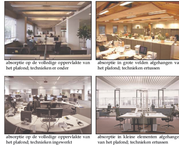
Figuur 2. Mogelijke oplossingen voor geluidabsorptie in (landschaps)kantoren
