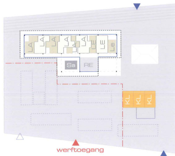
fase 2A •sloop overige paviljoenen •verhuis lagere school naar nieuwbouw •tijdelijke huisvesting drie kleuterklassen
