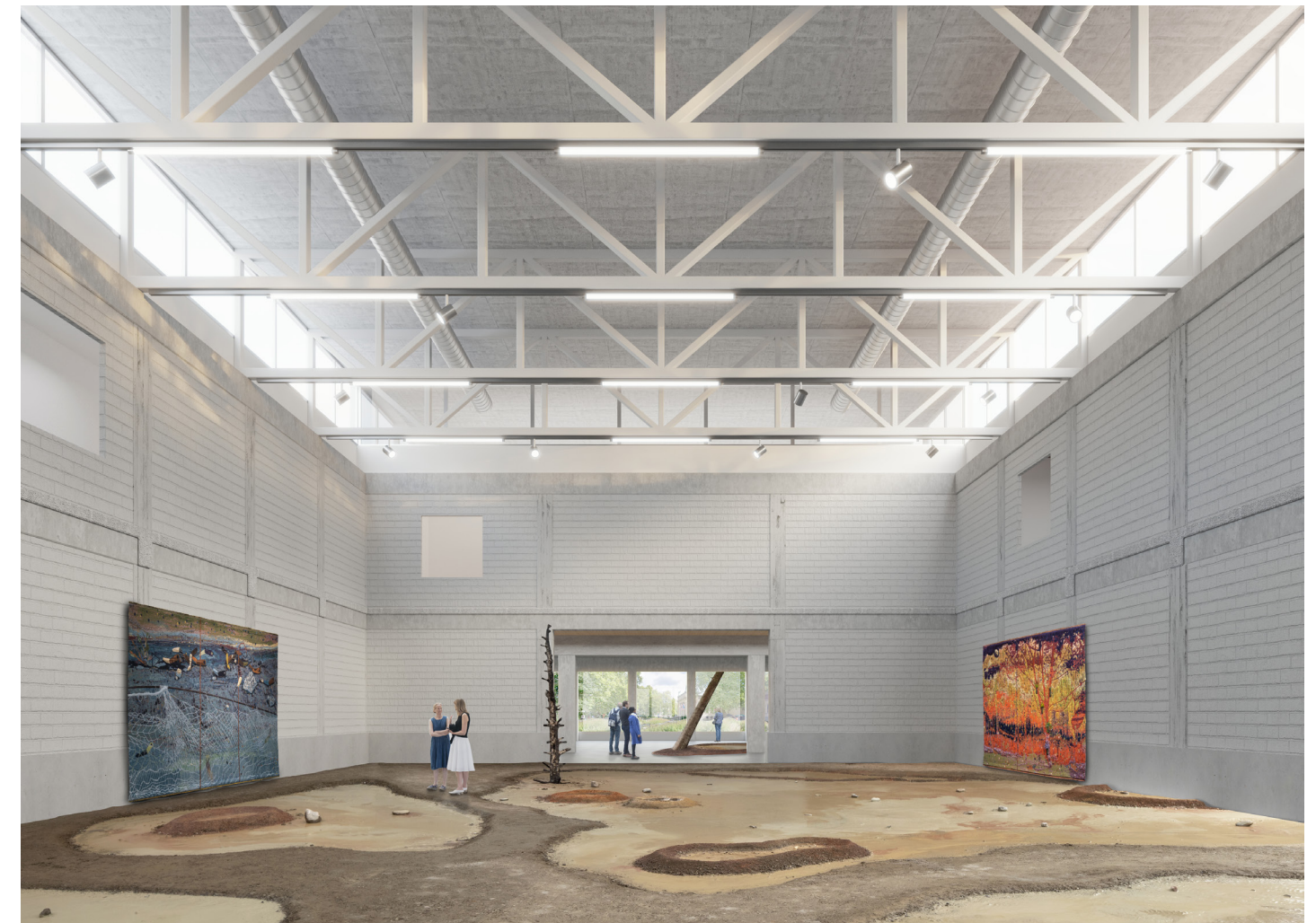
Door een vloerplaat te verwijderen vormt zich een centrale ruimte in de SMAK Hal. De bestaande structuur van beton en bakstenen wordt behouden, een nieuw dak biedt licht en ruimte.
