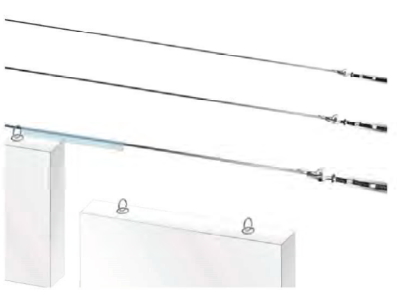
baffels opgehangen aan kabels die bevestigd worden tussen de structuur
