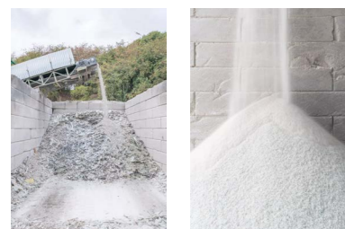
DING - baksteen gemaakt van 63% gerecyclede afvalaggregaten
