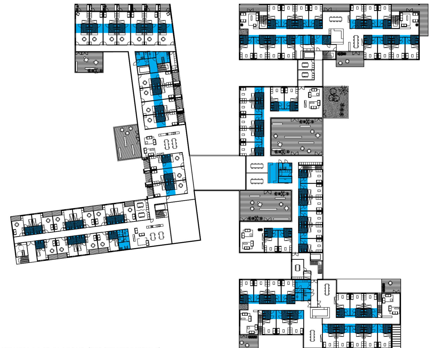
ZONE MET VERLAAGD PLAFOND (EERSTE VERDIEPING)
