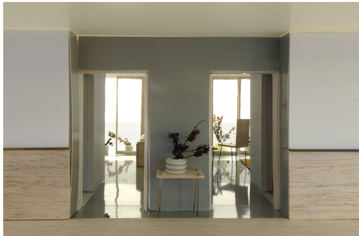
maquettestudies woonzorgkamers 1e verdieping: de 'voordeuren' van de kamers zijn geplaatst in een nis. Er is een duidelijke scheiding tussen de privé- ruimte van de bewoner en de collectieve ruimten van het huis.
