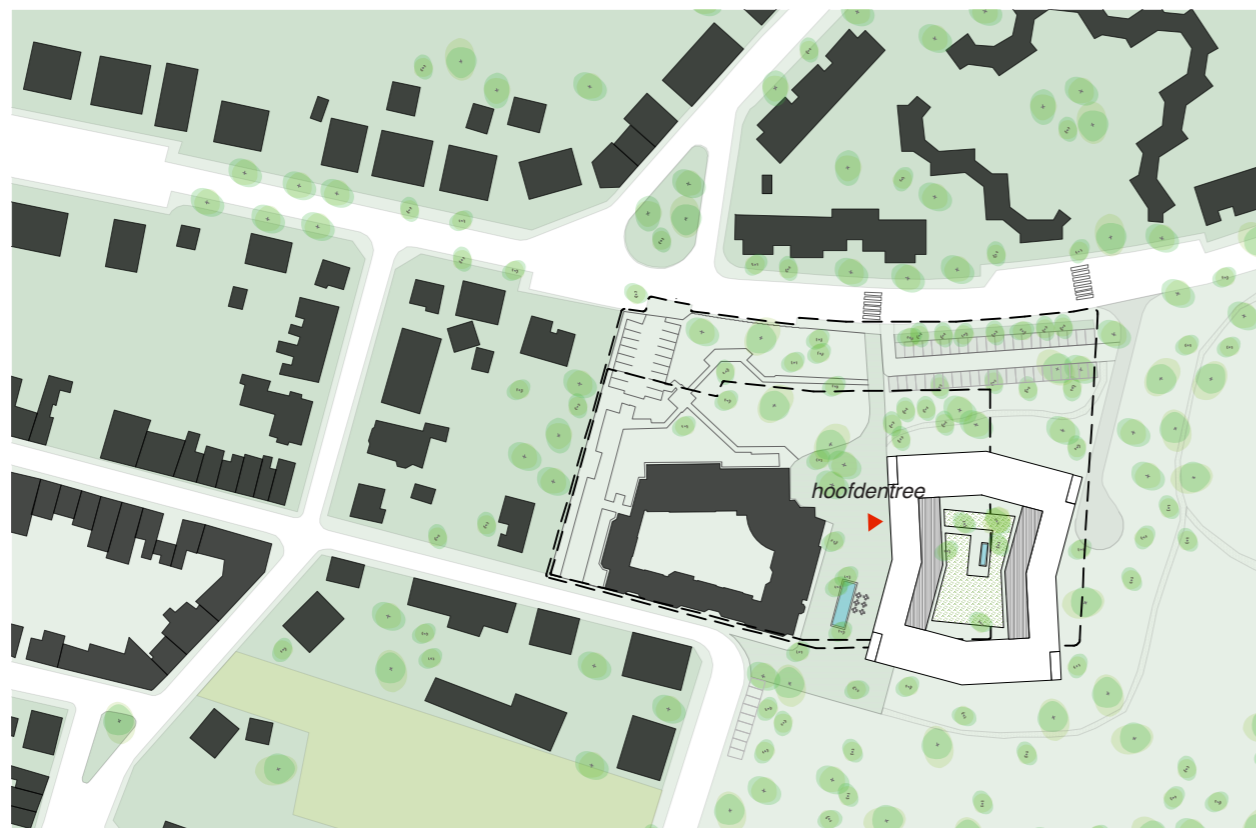
fase 2, sloop L-vormig blok, voltooiing hofgebouw, aanleg campusplein
