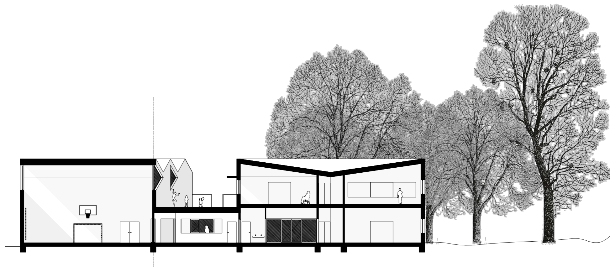
langssnede door turnzaal, refter, vestibule en het klasblok met de kenmerkende dakvorm - 1/250
