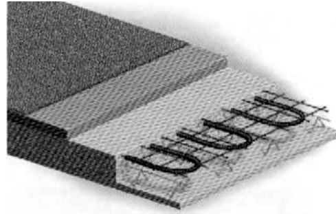
Vloerverwarming en koeling
