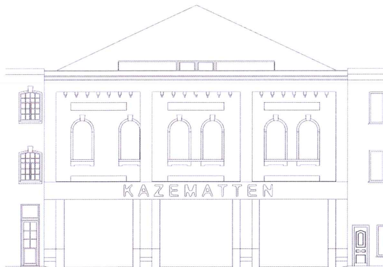
2. BESTAANDE, AANGEPASTE GEVEL: de bestaande gevel wordt gerestaureerd in al zijn details, de penanten komen op het gelijkvloers vrij te staan om de toegankelijkheid en zichtbaarheid van het gebouw te vergroten
