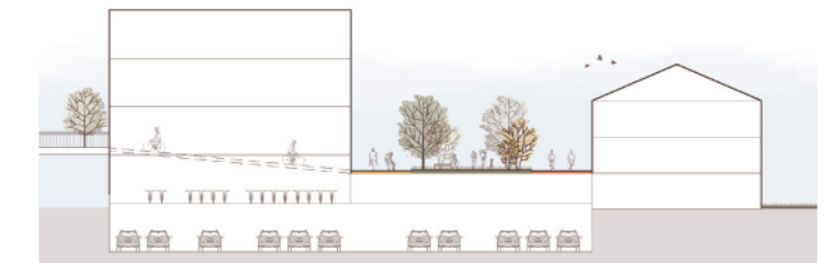
b) Geïntegreerde brughelling in gebouw
