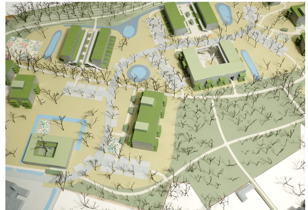
Axonometrie - detailtekening met daarop de hiërarchieën en gebruikers van de verschillende paden en de meanderende weg 1. meanderende weg, gedeeld door alle gebruikers: voetgangers, fietsers en auto's, zonder duidelijke zonering 2. hoofd voet- en fietspad 3. secundaire paden voor voetgangers en fietsers 4. secundaire paden in waterdoorlatende materialen
